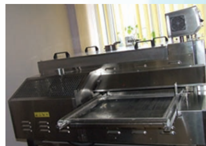
Aparat de uscare-termofixare-condensare-vaporizare pentru operatii intermediare si finale de finisare superioara (ROACHES, Anglia)
