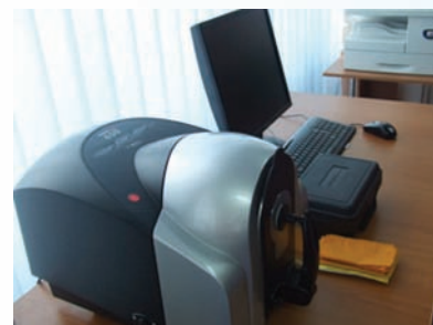
Spectrofotometru dual reflectanta/transmitanta pentru masuratori de grad de alb si de culoare (DataColor, Elvetia)
