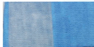
Tricot patat cu albastru metilen si metil oranj expus 14 ore la lumina vizibila (Xenotest)
