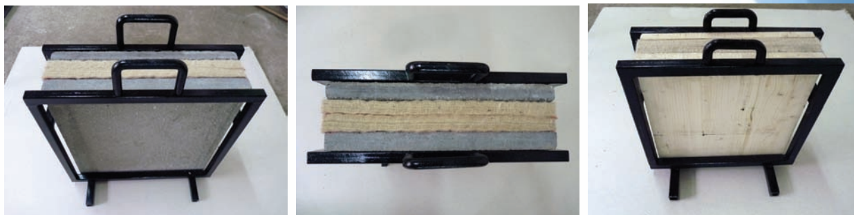
Fig. 43. Structuri termoizolante pe baza de panouri din lana a) beton-lana-beton; b) rigips – lana-rigips; c) lemn-lana-lemn
