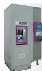
Fig. 71. Sistem CAD-CAM pentru prelucrarea calapoadelor, NL-MOD2RF
