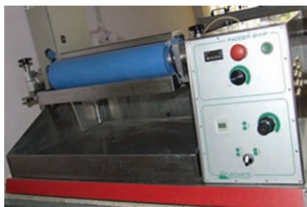
Fular pentru impregnarea materialelor textile cu substante polimerice si de functionalizare (ROACHES, Anglia)
